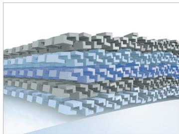
Detalhe em microscópio de uma lente com tecnologia antirreflexo convencional. As camadas da lente não estão densamente compactadas.
